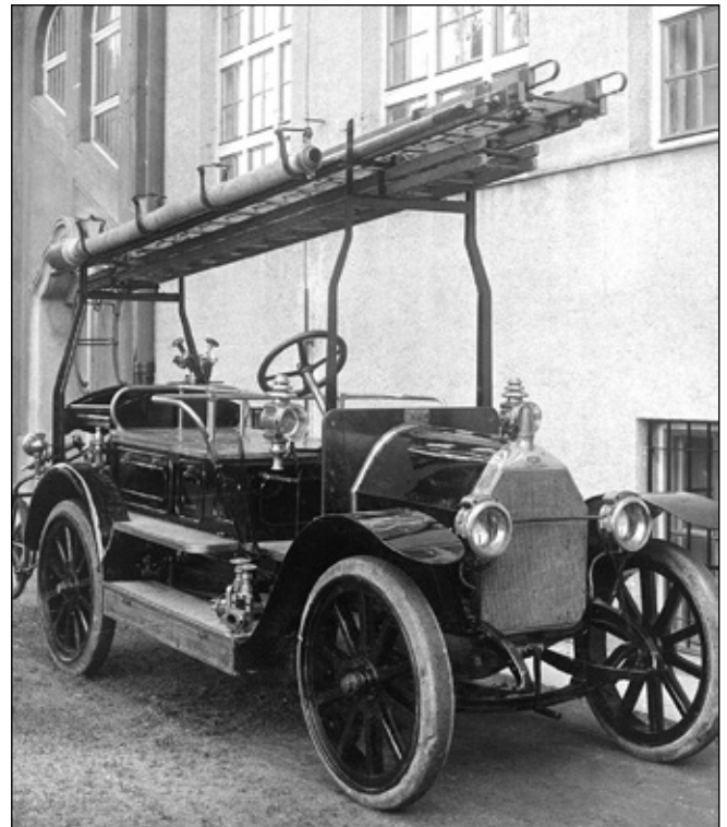
LF Fiat Type 1C / Aufbau Fa. Konrad Rosenbauer, Linz / Vergasermotor / Viertakt / Vierzylinder / ~16,2 kW (22 PS) / Bauartgeschwindigkeit ~45 km/h / zulässige Gesamtmasse 3.800 kg / Besatzung 8 Personen. (Wesentliche) Ausrüstung: Feuerlöschpumpe Rosenbauer im Heck mit 600 l/min bei 6 bar / Leitergerüst mit zweiteiliger tragbarer Schiebleiter / zwei Hakenleitern / Saug- und Druckschläuche / fahrbare Schlauchhaspel im Heck / saug- und druckseitige Armaturen, Unterflurhydranten-Standardrohr. (Siehe auch „Historische Schriftenreihe“ Heft 5, Folge 2/2008).
