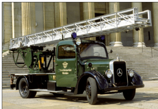
LDL (DL 17) auf Fahrgestell MB L 1500, Aufbau Metz (Aufnahme H.-J. Profeld)
