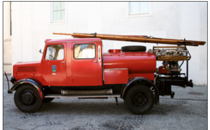
TLF („Wiener Modell“) auf Opel 3,6 Allrad, Aufbau durch österr. Industrie auf ehem. Fahrgestell der Wehrmacht
