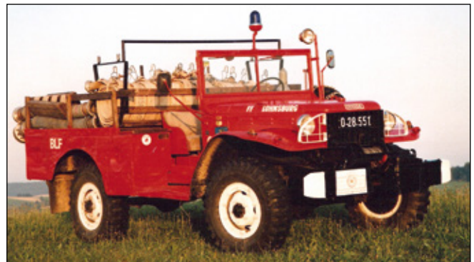
BLF („Berglandlöschfahrzeug“) Dodge, 4x4 Allrad, auf Fahrgestell der amerikanischen Besatzungsmacht
