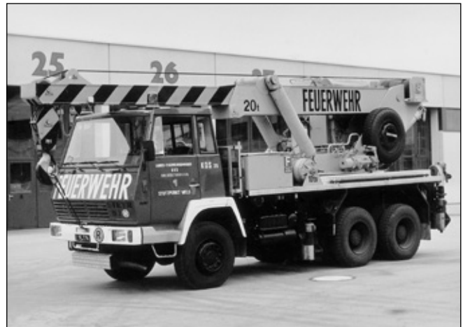
Kranfahrzeug „Kirsten“, auf Steyr Daimler Puch AG K 34, 6x6, Dieselmotor 191 kW (260 PS), Besatzung 3 Personen, Kranhubleistung max. 200 kN, Einbauseilwinde 100 kN im direkten Zug.
