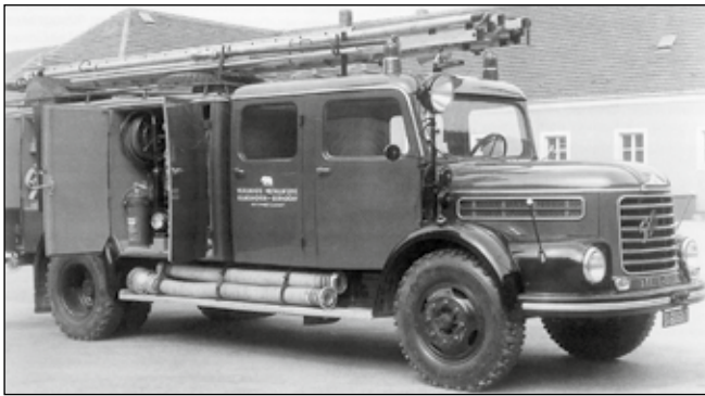
Universallöschfahrzeug der BTF VMW (heute AMAG) Ranshofen: ULF auf Steyr 586 Allrad, Dieselmotor 88 kW (120 PS), zulässiges Gesamtgewicht 12000 kg. Besatzung TLF-Gruppe 1:6, Löschwassertank 1250 l, Schaummittelvorrat 250 l, Pulverlöschanlage 750 kg, FP im Heck (HNDP R 6500 mit 250 l/min bei 40 bar bzw. 1250 l/min bei 10 bar)
