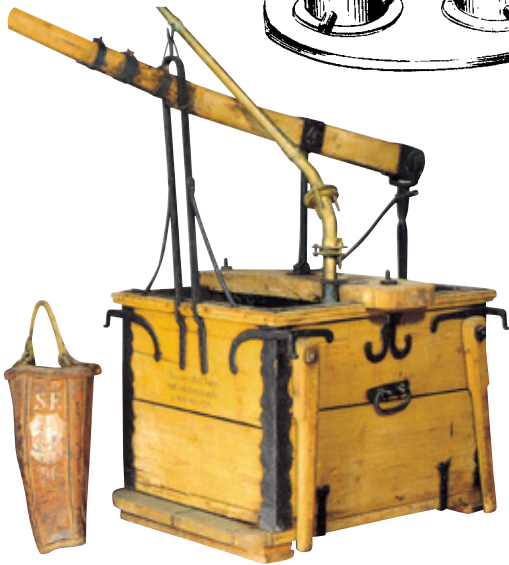
Kastenspritze ohne Saugwerk, Mitte 18. Jh., Wasserversorgung mittels Löscheimer
