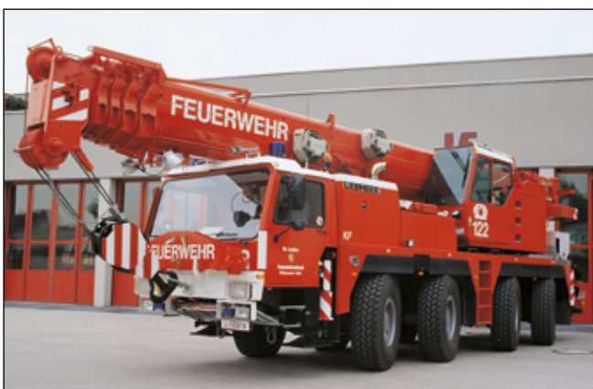
Kranfahrzeuge zweite Generation Liebherr Stützpunktkranfahrzeuge Liebherr, Type LTM 1070/1, Fahrgestell und Aufbau Liebherr GmbH, Ehingen, BRD, zulässiges Gesamtgewicht 48000 kg, Dieselmotor 308 kW (408 PS), Bauartgeschwindigkeit 70 km/h, Besatzung 3 Personen (1:2), Einbau-Seilwinde 200 kN in direktem Zug, Kranhublast maximal 500 kN, Abschleppeinrichtung Traglast max. 80 kN.
