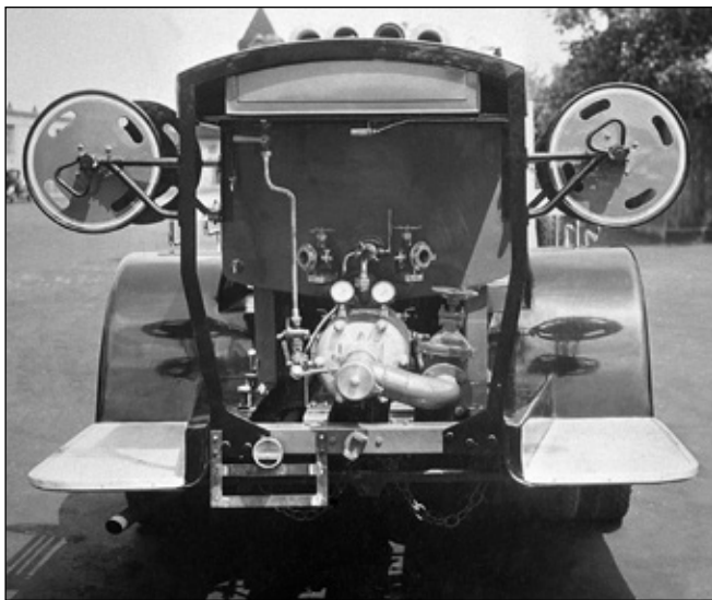
TLF auf ÖAF AFO 25 / Hersteller Österreichische Automobilfabrik Wien / Aufbau Fa. Wilhelm Knaust, Wien / Baujahr 1937 / Vergasermotor / Viertakt / Vierzylinder / Wasserkühlung / ~44,1 kW (60 PS) / Bauartgeschwindigkeit ~60 km/h / zulässige Gesamtmasse 7000 kg / Besatzung 7 Personen (TLF-Gruppe 1:6)
