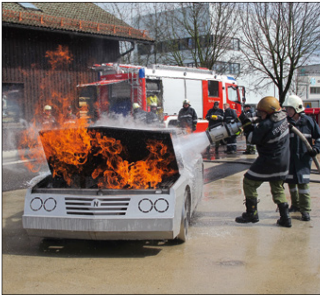
Brandbekämpfung mit verschiedenen Löschmitteln am Übungs-PKW der mobilen gasbefeuerter Übungsanlage.
