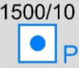
1500/10<br>P | Ortsfeste Pumpe mit Angabe der bei der Nennleistung erreichbaren Fördermenge in l/min und der Förderhöhe in m                                                                                                                          |
