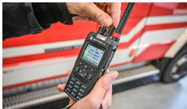
Abbildung 43 Gruppenwahlschalter des Handfunkgerätes neben der Antenne, © Hubert Wilflingseder
