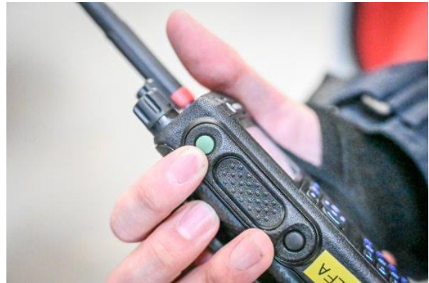
Abbildung 46 grüne Home-Taste und schwarze Umschaltung DMO/TMO am Handfunkgerät © Hubert Wilflingseder
