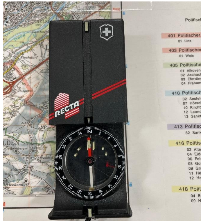
Abbildung 95 Karte so lange drehen, bis der obere Kartenrand und der rote Pfeil des Kompasses in dieselbe Richtung zeigen, © Hubert Wilflingseder
