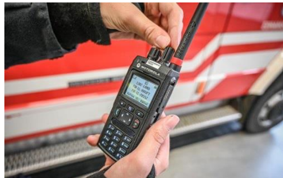
Abbildung 12 Sprechgruppenwechsel durch drehen des längeren Drehschalters, © Hubert Wilflingseder
