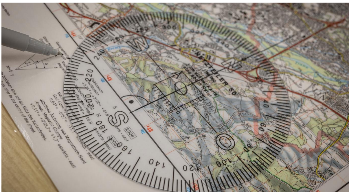
Abbildung 105 Fadenkreuz auf Punkt A legen und die Nord-Süd-Markierung auf die Hilfslinie ausrichten. Anschließend den gemessenen Richtungswinkel von 230^\circ auftragen und den Punkt A mit der gesetzten Markierung mit einer Linie verbinden. © Hubert Wilflingseder
