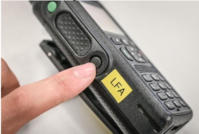
Abbildung 24 Taste zum Umschalten zwischen Direktmodus (DMO) und Netzmodus (TMO) © Hubert Wilflingseder
