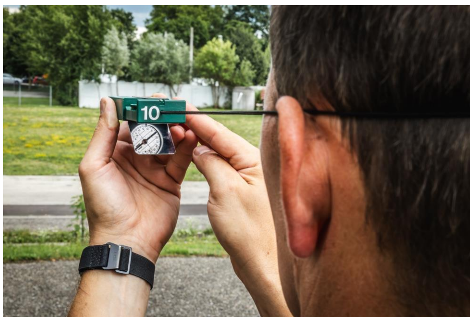
Abbildung 102 anvisieren des bekannten Punktes, Drehrad so lange drehen, bis die zwei Striche links und rechts des Nordpfeiles sind, © Hubert Wilflingseder
