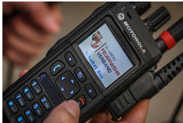
Abbildung 41 rote Taste länger drücken, um das Gerät ein- oder auszuschalten, © Hubert Wilflingseder
