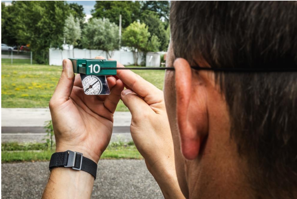
Abbildung 99 anvisieren des bekannten Punktes, Drehrad so lange drehen, bis die zwei Striche links und rechts des Nordpfeiles sind, © Hubert Wilflingseder
