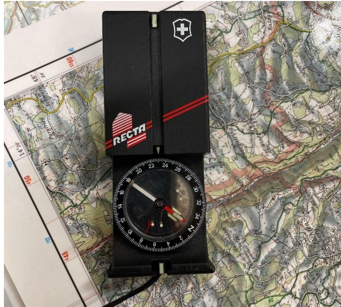
Abbildung 103 Drehrad wurde mit Nordpfeil in Übereinstimmung gebracht, das Ablesen des Richtungswinkels kann erfolgen, © Hubert Wilflingseder
