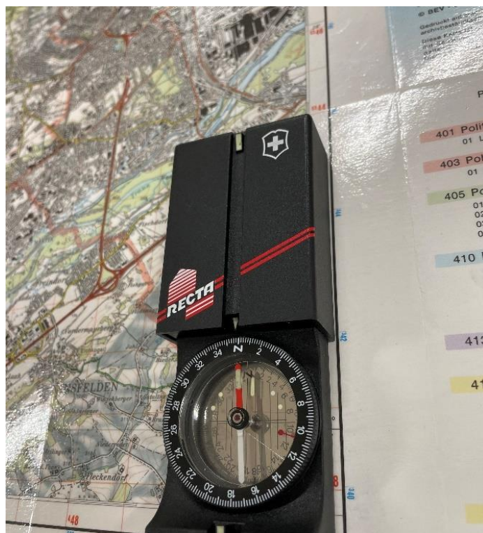
Abbildung 94 am rechten unteren Kartenrand korrekt ausgerichteter Kompass, © Hubert Wilflingseder
