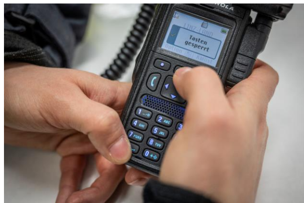
Abbildung 42 Tastensperre durch Drücken der Menü- und anschließend der Stern-Taste aktivieren und deaktivieren, © Hubert Wilflingseder
