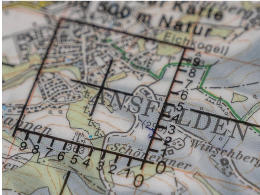
Abbildung 91 Netzteiler liegt deckungsgleich auf dem Gitterquadrat, © Hubert Wilflingseder
