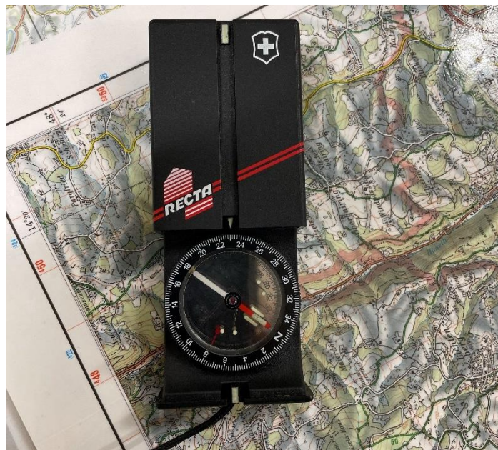
Abbildung 100 Drehrad wurde mit Nordpfeil in Übereinstimmung gebracht, das Ablesen des Richtungswinkels kann erfolgen, © Hubert Wilflingseder
