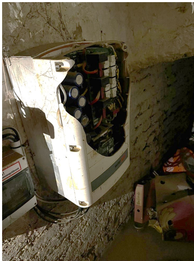
Wechselrichter nach Knallgasexplosion
