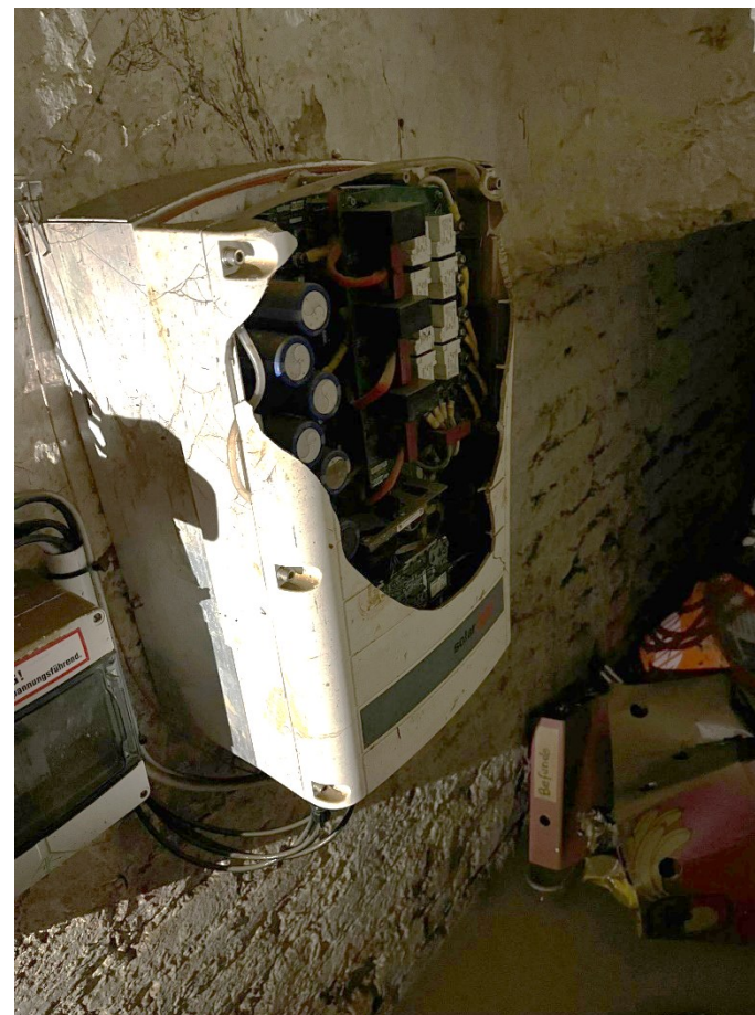
Wechselrichter nach Knallgasexplosion
