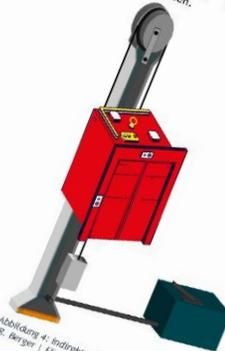
Abbildung 4: Indirekt hydraulischer Aufzug (z. B. Regler | FF-W, Westcott)
