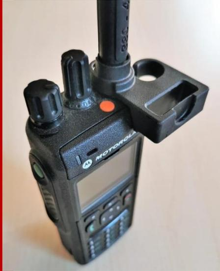
Immer wieder bekommen wir „defekte“ Handfunkgeräte, bei denen nur die Antenne durch die Zubehör-Mikrohalterung gelockert wurde!
