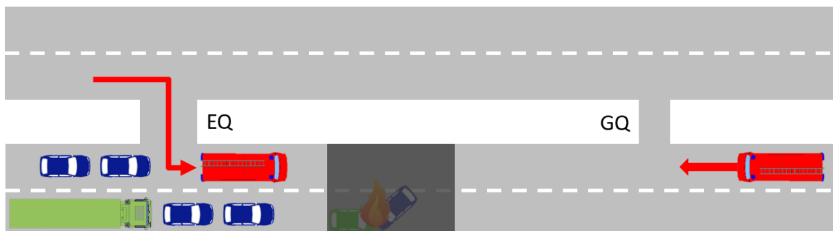
Abb. 14: Einfahren in einen zweiröhrigen Tunnel, © OÖLFS
