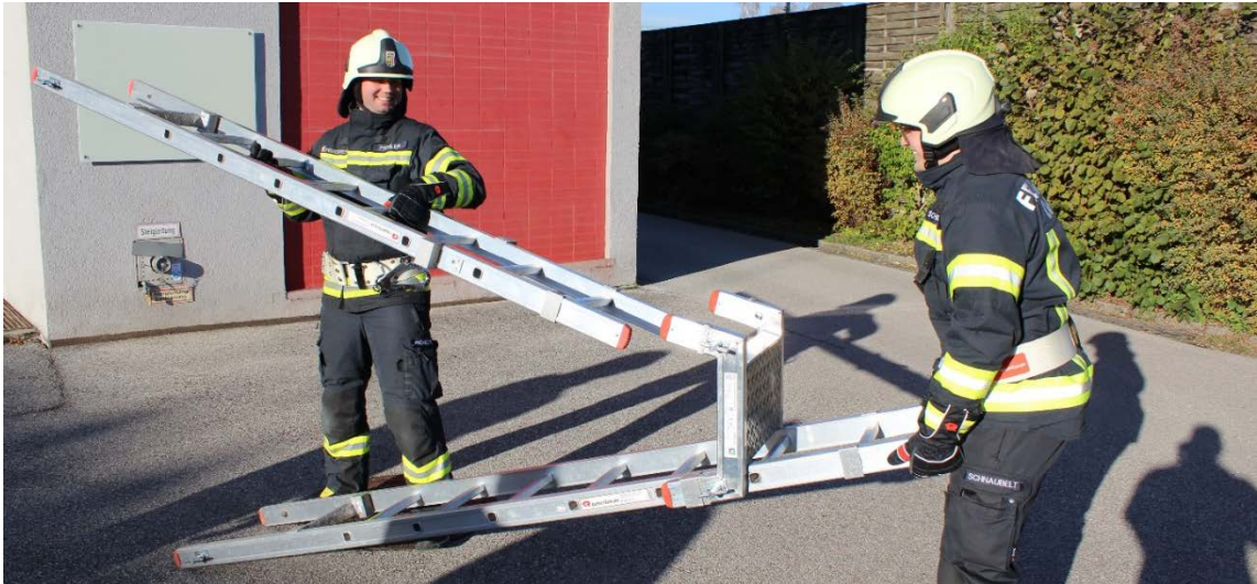
Aufbau einer Bockleiter.
