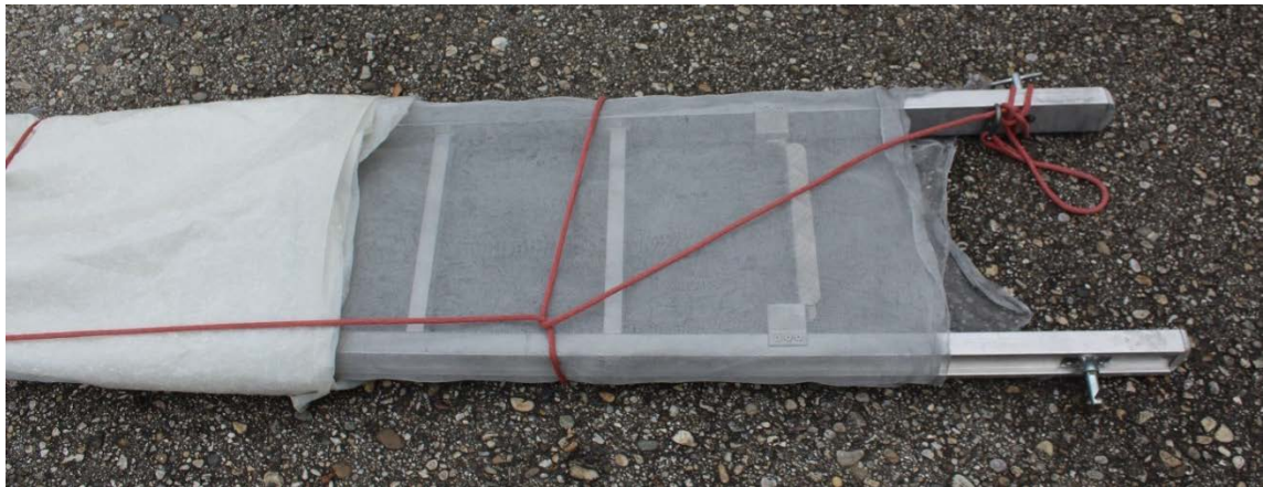
Engmaschiges Drahtnetz einer provisorischen Ölsperre.
