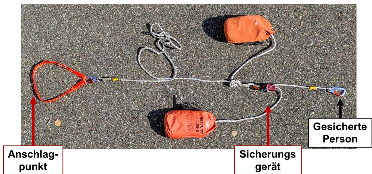
Abbildung 1: Sicherungskette mit Sicherungsgerät
