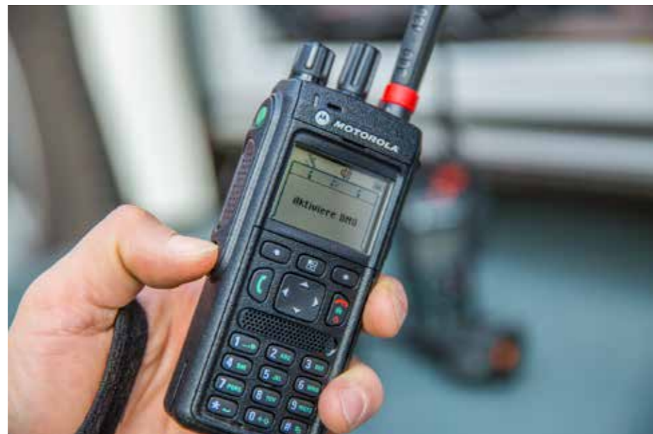
Einfacher Wechsel in die Betriebsart „DMO“ per 3-Sekunden-Tastendruck.
