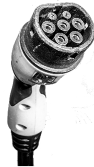
Abbildung 49: Typ 2 Stecker (FEUERWEHR.AT | R. Berger)
