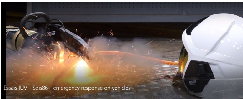
Abbildung 2: Lichtbogen beim Trennen einer 48 Volt Leitung (Sapeurs-pompiers de la Vienne, ÖBFV Film Gefahrenlehre)
