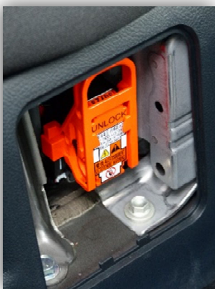
Abbildung 14: Service Disconnect - Wartungsstecker (Winterschulung 2017/18, SFS Würzburg)
