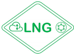
Abbildung 35: Piktogramm mit Kennzeichnung von LNG Antrieb nach ISO 17840
