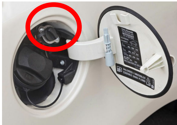
Abbildung 43: Zusätzlicher Tankstutzen für die Betankung von Erdgas (Volkswagen AG)
