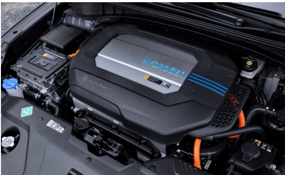
Abbildung 21: Motorraum eines Fahrzeuges mit Brennstoffzelle (Hyundai)
