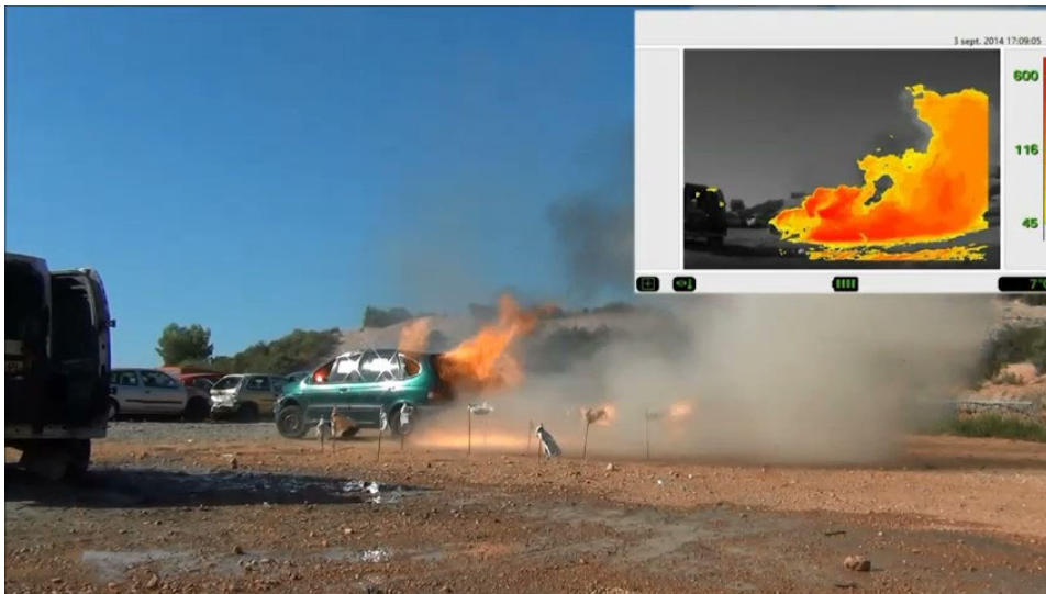
Abbildung 22: Ausgelöste Sicherheitseinrichtung bei einem brennenden Wasserstofffahrzeug (Sapeurs-pompiers de la Vienne)
