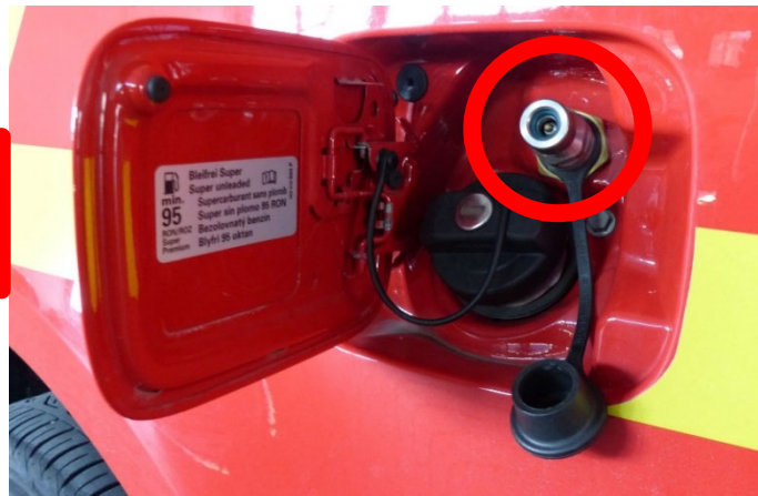
Abbildung 28: Zusätzlicher Tankstutzen für Betankung von Erdgas (SFS Würzburg Winterschulung „Alternative Antriebe“)
