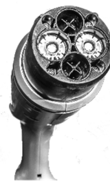
Abbildung 51: Chademo Stecker (FEUERWEHR.AT | R. Berger)
