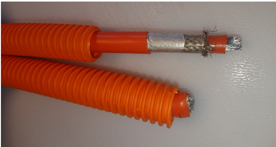
Abbildung 6: Aufbau eines Hochvoltkabels (Hubert Springer, ÖBFV)
