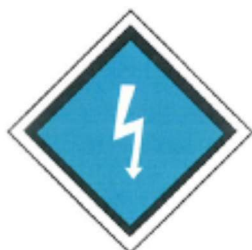
Abbildung 27 – Signal „An die Vorheizanlage angeschlossen“
