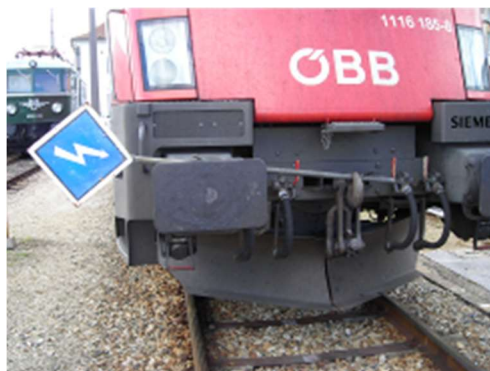
Abbildung 27 – Signal „An die Vorheizanlage angeschlossen“
