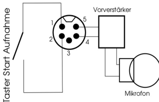
Bis jetzt wurde die Schaltung von der alten Funksirenensteuerung versorgt, für den Weiterbetrieb ist eine Anschaltung an eine andere Stromversorgung 12V (z.B. Batterie der Florianstation) notwendig,
