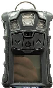
Sollte ein Gerät der **Firma MSA** betrieben werden, muss nur darauf geachtet werden, dass die **richtige Prüfgasflasche** verwendet wird. Der Druckminderer ist gleich (weil genormte Anschlüsse) und der Kalibrieradapter liegt dem Gerät bei.
